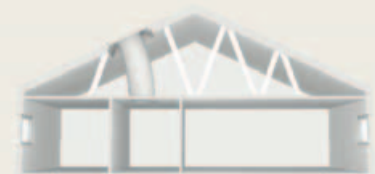
Flexibilis csöves fénycsatorna magastetőbe
