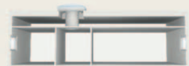
Merev vagy flexibilis csöves fénycsatorna lapostetőbe
