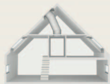
Merev csöves fénycsatorna magastetőbe
